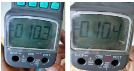
ภาพที่ 5 วัดค่ากระแสไฟฟ้าที่ได้จากการชาร์จ
