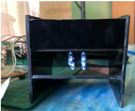
รูปที่ 4 เซนเซอร์สีที่ใช้แยกธนบัตร
