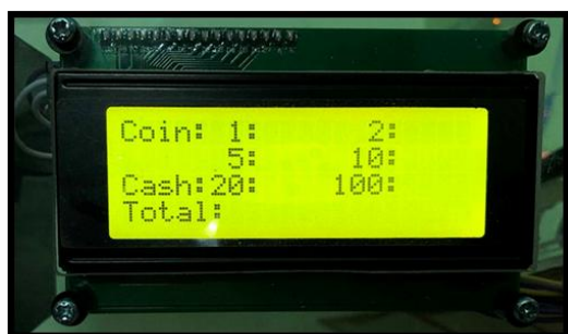
รูปที่ 9 หน้าจอแสดงผลของเครื่องกระปุกออมสิน นับเงินอัตโนมัติ
