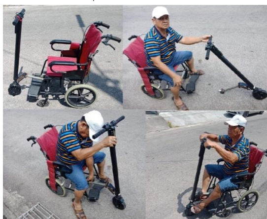
ภาพที่ 3 การประกอบและทดลองขับอุปกรณ์ลากจูงระบบไฟฟ้าสำหรับรถนั่งคนพิการ
